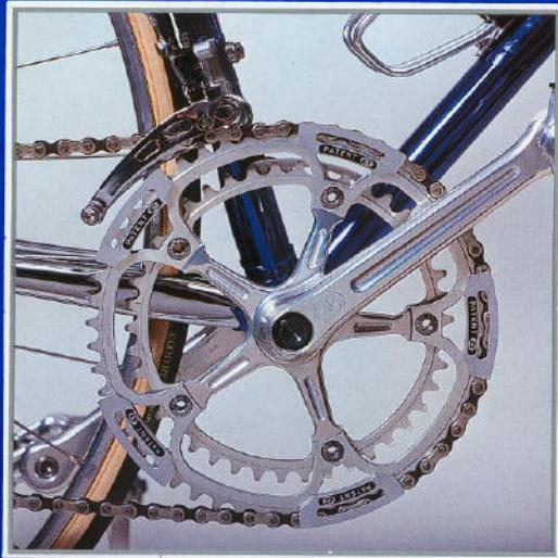
Kettenführungs-Zusatz (KFS), von der ICS entwickelt und patentierte. Er vermeidet das Herausfallen der Kette an beiden Kettenräder während der Gangschaltung, bedingt durch zu grosses Schrägläufen der Kette, oder durch mechanischen Verschleiss sowie beim Auswechseln des Hinterrades.
