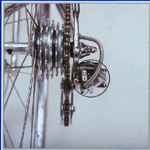
Régulateur de la diagonale du changement de vitesse: Système 3-D. Conçu et réalisé par ICS, breveté. Il est appliquée sur le changement de vitesse «Campagnolo Super Record» et permet, grâce à un plus grand enroulement de la chaîne sur le pignon de la roue libre, une transmission optimale de la force mécanique, moins d'usure et moins de risque de chute de la chaîne. Idéal pour les roues libres à 6 ou 7 couronnes à 11, 12, 13, 14 empreintes.
