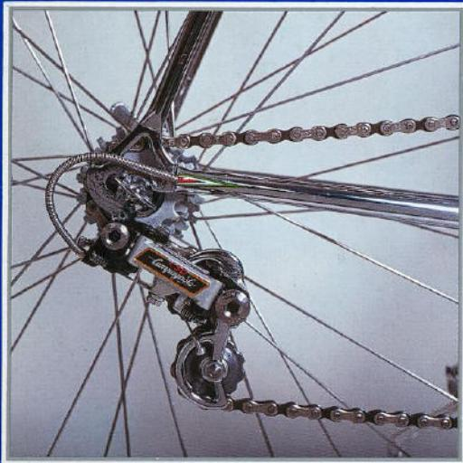
Feinstellung der Wechsel-Diagonale: 3-D System. Durch ICS entwickelt und patentiert. Wird am Kettenwechsel «Campagnolo Super Record» angebracht. Diese ermöglicht, durch die erhöhte Wicklung der Kette auf den Freilaufzahnkranz, eine optimale Kraftübertragung, einen verminderteren mechanischen Verschleiss sowie ein beschränktes Überspringen der Kette. Ideal für 6-oder 7-fach Leertäufe mit 11, 12, 13, 14 Zähnen.
